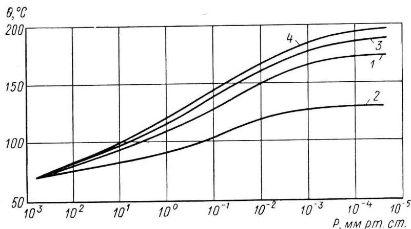
Перегрев обмотки реле РЭС49 в зависимости от изменения атмосферного давления окружающего воздуха:
