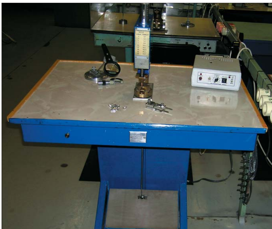
Рисунок. Внешний вид сварочной машины МТ-5 для контактной микросварки
